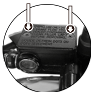
Imagen 26. Completar el nivel del líquido de freno.
