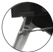
Imagen 24. Ajuste del pedal del freno trasero.
