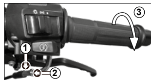
Imagen 19. Ajuste del puño del acelerador.
