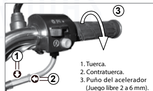
Imagen 18. Ajuste del puño del acelerador.
