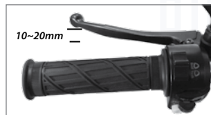
Imagen 19. Ajuste de la palanca del embrague.
