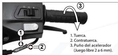
Imagen 17. Ajuste del puño del acelerador.
