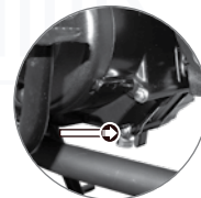
Imagen 14. Ubicación del tornillo de drenado.
