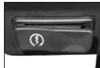
Imagen 3. Interruptor de arranque eléctrico.
