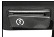
Imagen 3. Interruptor de arranque eléctrico.
