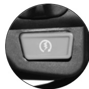
Imagen 2. Interruptor de arranque eléctrico.
