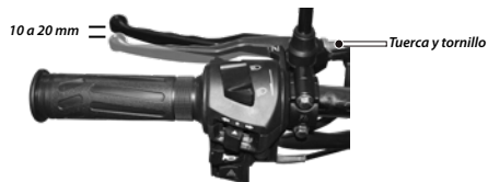
Imagen 20. Ajuste de la palanca del embrague.
