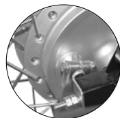
Imagen 23. Indicador de desgaste del freno trasero.
