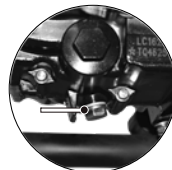
Imagen 16. Ubicación del tornillo de drenado.
