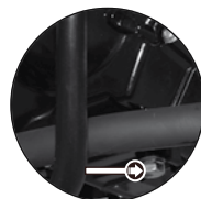
Imagen 14. Ubicación del tornillo de drenado.
