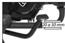
Imagen 21. Ajuste del pedal del freno trasero.
